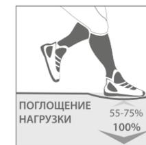
Фактор показывающий в процентах, насколько спортивное покрытие смягчило приземление атлета, по сравнению с абсолютно жестким основанием (например, бетонной плитой). Оптимальный тип спортивного пола должен уменьшать реакцию опоры на 55...75%. Именно этот диапазон обеспечивает комфорт суставам спортсмена, не приводя при этом к снижению скорости игры.
